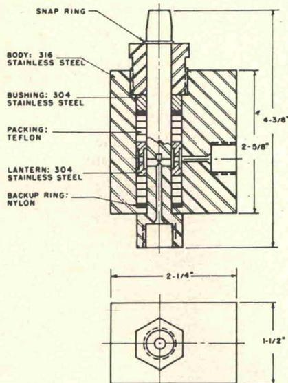
FIG. 4—AUTOCRAVE 0.25-IN. HIGH PRESSURE SWIVEL JOINTS.
